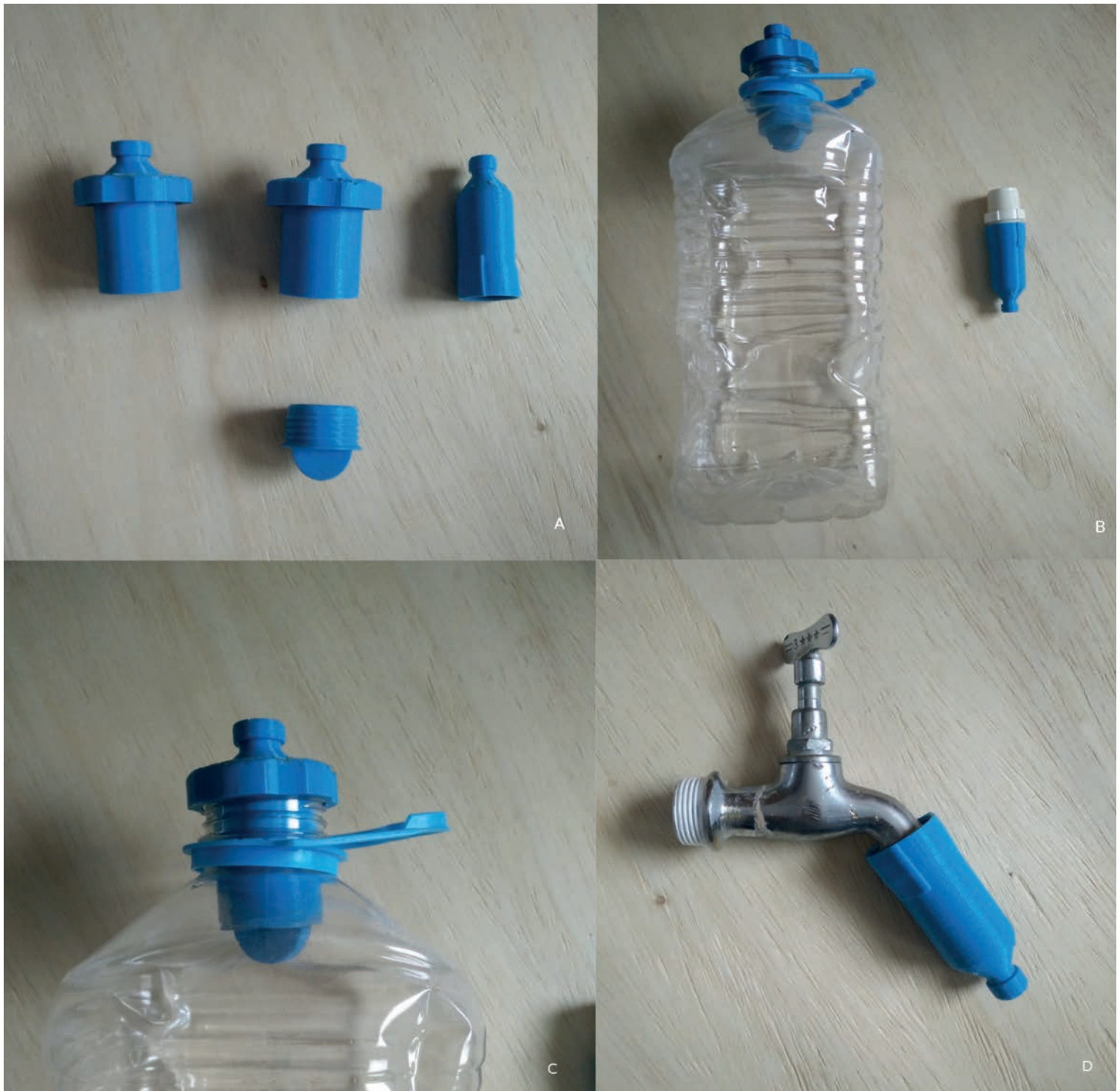
Fig 2. Cápsulas do filtro impressas em 3D (Sem carvão ativado). (A) O modelo original (à esquerda) e versões adaptadas. (B) Versão adaptada acoplada à um galão de 5 litros e à um adaptador 3/4". (C) Detalhe. (D) Versão adaptada e acoplada à uma torneira comum.
